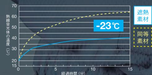
ランプを照射後15分後に対比試料 (同等素材) が64°Cに対して遮熱素材は41°Cであった。対比試料に比べて-23°Cとなった。
