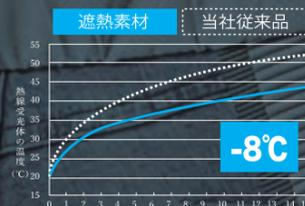
ランプを照射後15分後に対比試料(同等素材)が52°Cに対して遮熱素材は44°Cであった。対比試料に比べて-8°Cとなった。
