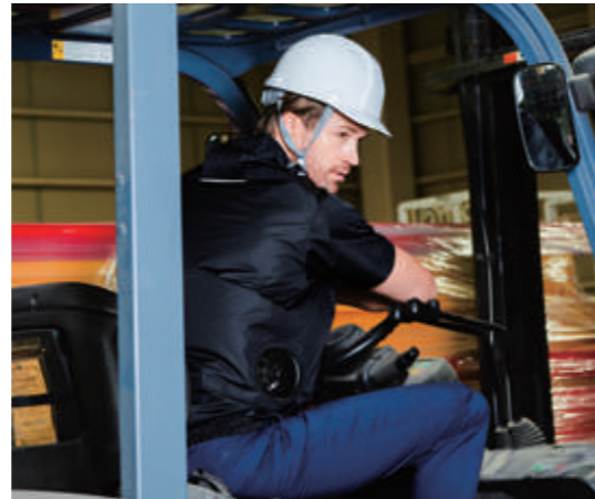
3 横付ファン 車の運転や椅子に座った作業時でも、背もたれ等にファンが当たりにくい。
